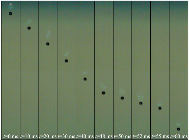
图 4 正十二烷液滴( D_0 = 2.6 \text{ mm} )边界层火焰向倒锥形火焰的转变过程
